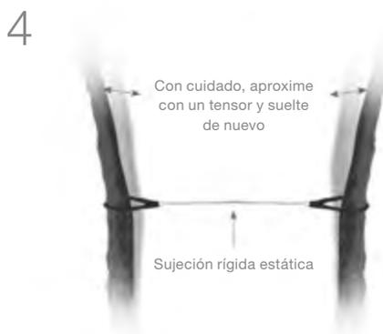
El sistema cobra ultrastatic ha sido concebido especialmente para el uso en horcaduras con fracturas. El sistema es idóneo para impedir la progresión de estos daños gracias a un reducido alargamiento del cable de 0,2 % por tonelada. El montaje se efectúa como sigue:
